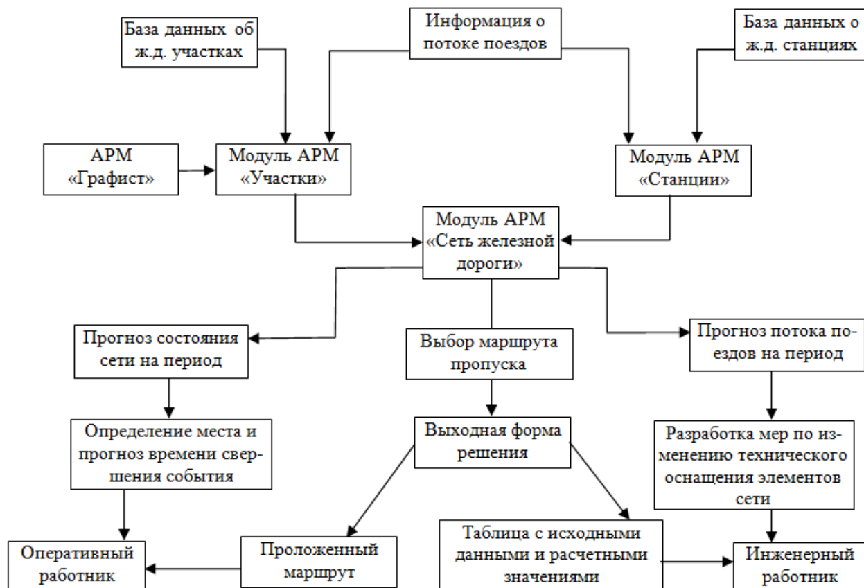
Рис. 1. Схема программного комплекса «Сеть железной дороги»
