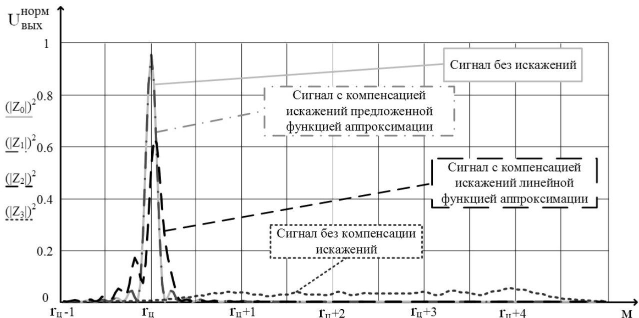
Рис.3. Компенсация искажений ЛЧМ сигнала с помощью функций аппроксимаций ГВЗ.
